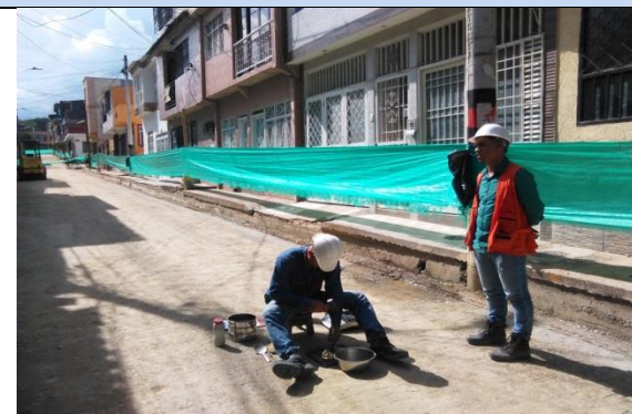
Ilustración 28. Toma de densidades en la capa de subbase granular.
